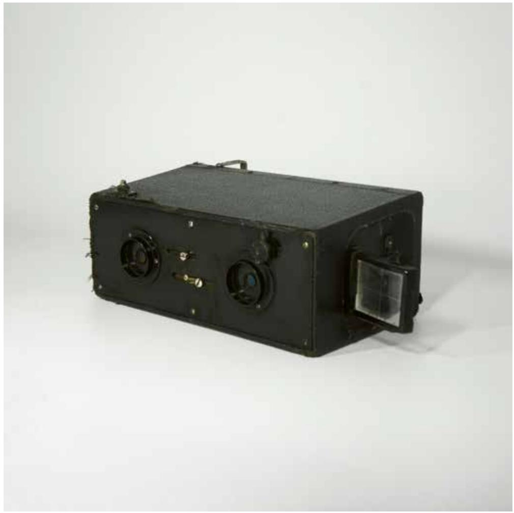
***Cámara estereoscópica Ica-Polyscop***
